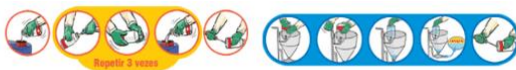
Figura 24: Tríplice lavagem e lavagem pressão das embalagens de agrotóxico - Fonte: INPEV, 2006.
